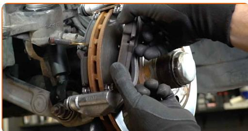
Menjava: zavornih ploščic – MERCEDES-BENZ Razred E Keson / Podvozje (VF211). AUTODOC nasvet:
