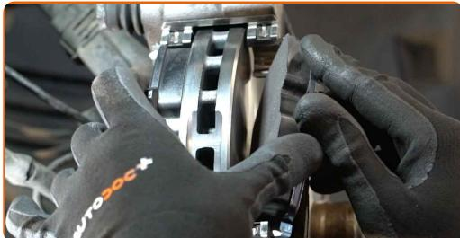
Menjava: zavornih ploščic – MERCEDES-BENZ Razred E Keson / Podvozje (VF211). AUTODOC priporoča:
