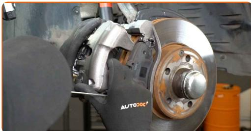
Menjava: zavornih ploščic – MERCEDES-BENZ Razred E Keson / Podvozje (VF211). Nasvet AUTODOC strokovnjakov:
