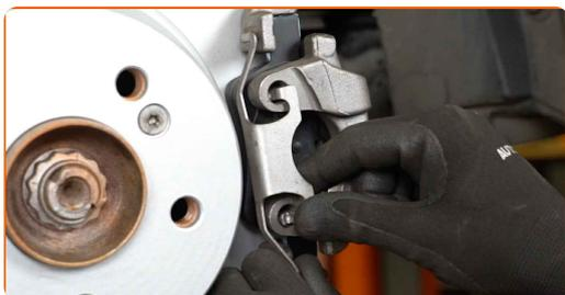
**36** Povežite senzor obrabe zavornih ploščic.
