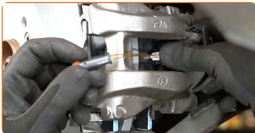
**37** Priključite vtič senzorja za obrabo zavornih oblog.
