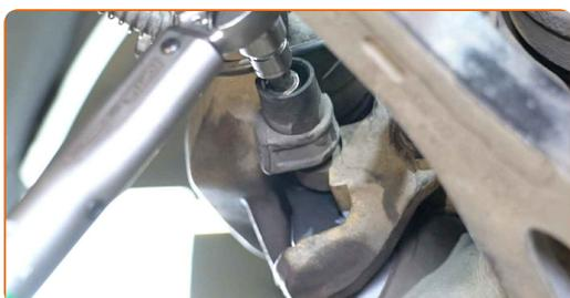
**34** Namestite pokrovčke manšete vodilnih zatičev zavornih čeljusti.
