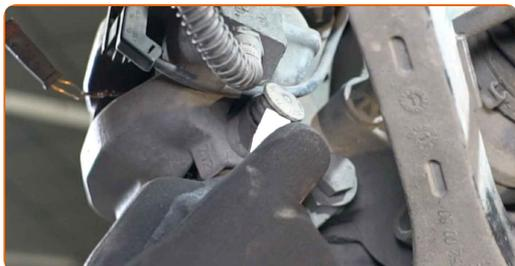
**11** Odvijte pritrditve zavorne čeljusti. Uporabite imbus št. H7. Uporabite izvijač z zatikalom.
