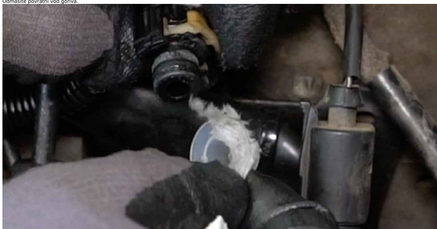
21 Priklopite cev povratnega voda goriva.
