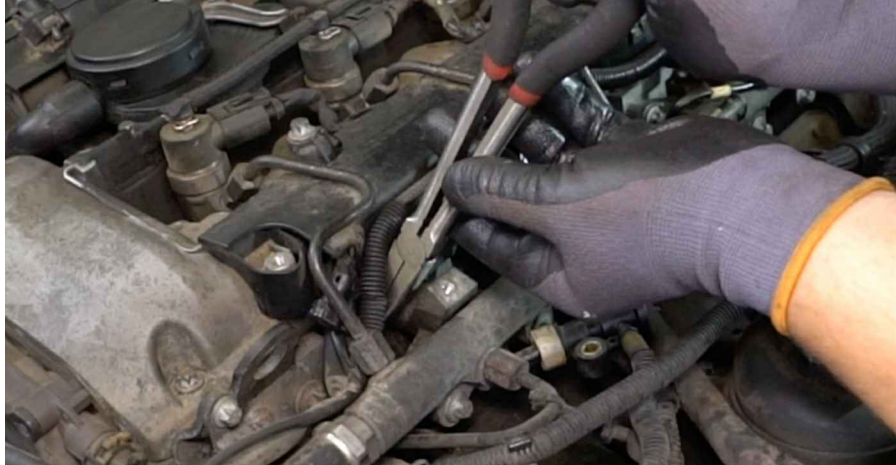
14 Obdelajte žarilne svečke. Uporabite visokotemperaturno keramično pasto.
