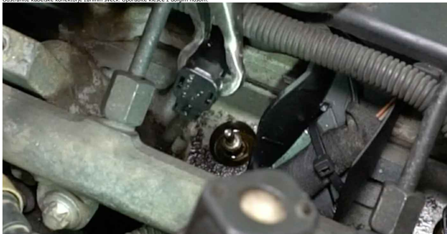
11 Očistite umazanijo, prah in drobne delce iz notranjosti navoja vžigalne svečke.
