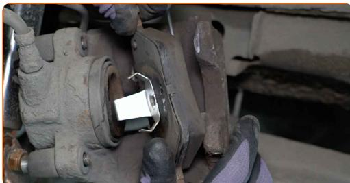
Menjava: zavornih ploščic – MERCEDES-BENZ Razred E Keson / Podvozje (VF210). AUTODOC priporoča:
