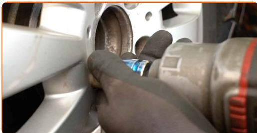
**37** Spustite avto in z delanjem v navzkrižnem vrstnem redu, zategnite kolesne vijake. Uporabite kolesni nasadni nastavek št. 17 Uporabite navorni ključ. Zategnite ga do navora 130 Nm.
