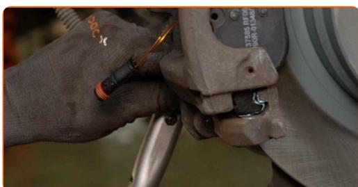
**25** Namestite pokrovčke manšete vodilnih zatičev zavornih čeljusti.
