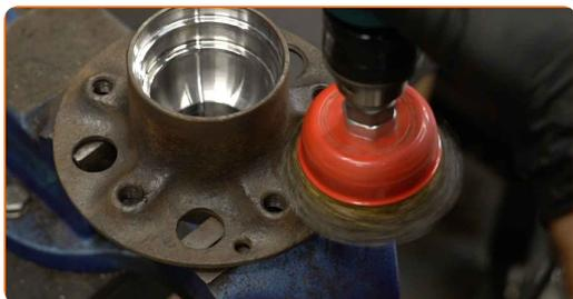
**33** Obdelajte vgradni prostor ležajnega sklopa. Uporabite večnamensko mast.
