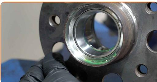
**38** Obdelajte vgradni prostor ležajnega sklopa. Uporabite večnamensko mast.
