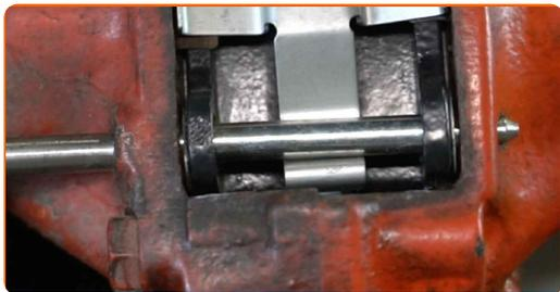
**17** Očistite površino zavornih kolutov. Uporabite čistilo zavor.
