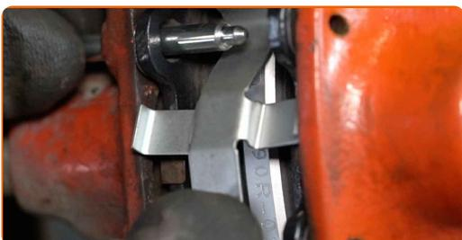
**16** Namestite vodilne čepe zavornih ploščic. Uporabite izbijač. Uporabite kladivo.
