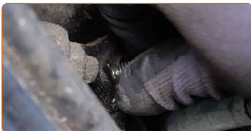
**28** Odstranite zatič, ki povezuje kabel s spojnim členom čeljusti parkirne zavore. Uporabite klešče z dolgim nosom.
