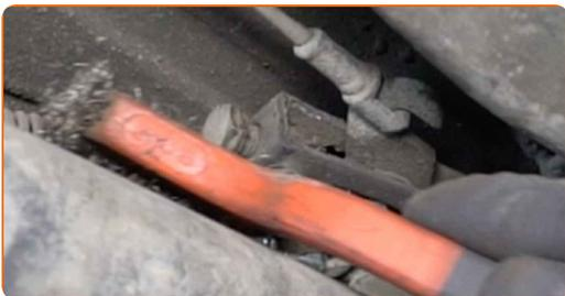
**31** Sprostite regulator kabla parkirne zavore. Uporabite nasadni ključ №13. Uporabite izvijač z zatikalom.
