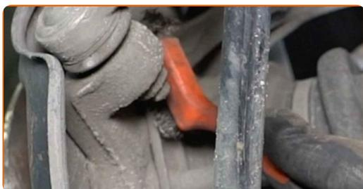
**26** Odvijte pritrdilni element, ki povezuje kabel parkirne zavore z zadnjim premnikom. Uporabite nasadni ključ N°13. Uporabite izvijač z zatikalom.
