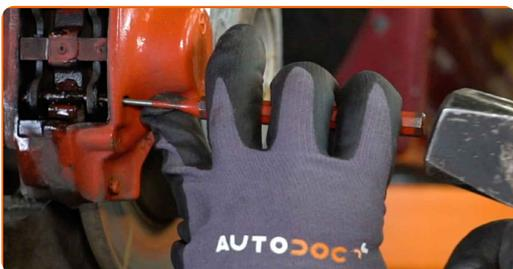
**10** Odstranite zadrževalno vzmet zavornih ploščic.
