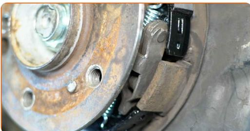
**45** Prilagodite napetost parkirnega zavornega kabla. Uporabite nasadni ključ N°13. Uporabite izvijač z zatikalom.
