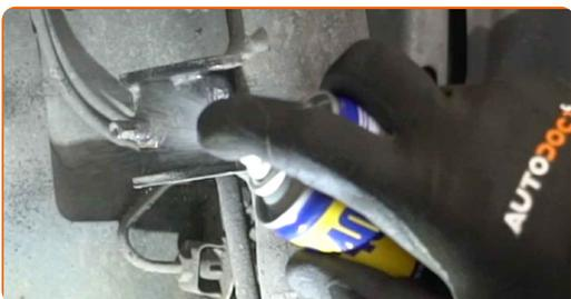
**11** Odvijte pritrdilni element, ki povezuje jarmov drog na blažilnik. Uporabite nasadni ključ №16. Uporabite izvijač z zatikalom.
