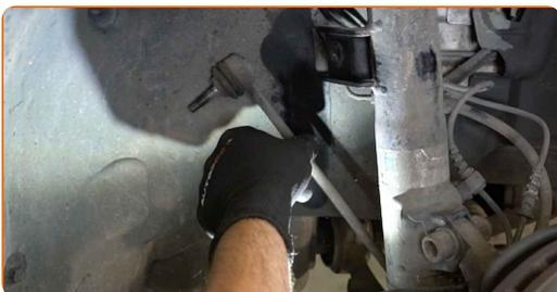
**13** Odklopite nosilec zavornih cevi. Uporabite rezalne klešče.
