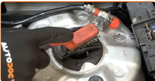
**4** Sprostite zgornji pritrdilni element sedeža za namestitev blažilnika. Uporabite kombinirani ključ №21. Uporabite imbus št. H7. Uporabite izvijač z zatikalom.
