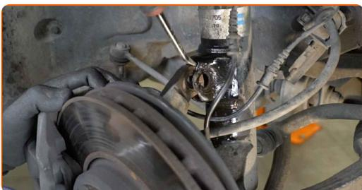
**25** Odvijte pritrdilne elemente na vrhu nosilca amortizerja.
