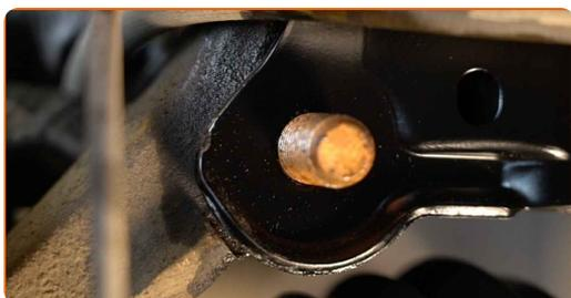
**27** Obdelajte površino, kjer se zavorni kolut stika s platiščem. Uporabite bakreno mast.
