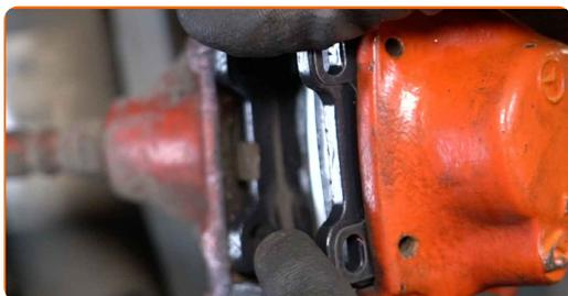
**44** Namestite zadrževalno vzmet zavornih ploščic.
