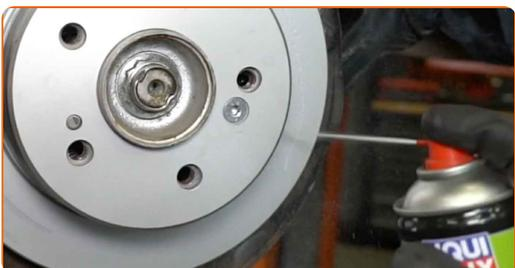
**47** Obdelajte površino, kjer se zavorni kolut stika s platiščem. Uporabite keramično pasto.
