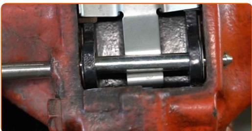
**46** Očistite površino zavornih kolutov. Uporabite čistilo zavor.
