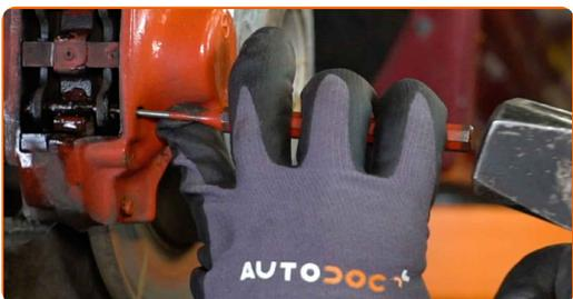
**10** Odstranite zadrževalno vzmet zavornih ploščic.
