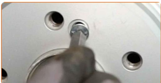
**38** Zategnite pritrdilne elemente zavornega koluta. Uporabite imbus št. H5. Uporabite navorni ključ. Zategnite ga do navora 10 Nm.
