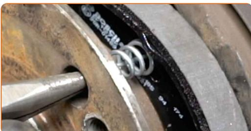
**33** Namestite spodnjo povratno vzmet. Uporabite ploščat izvijač.
