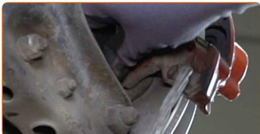
**42** Zategnite pritrdilne elemente zavorne čeljusti. Uporabite nasadni ključ №17. Uporabite navorni ključ. Zategnite ga do navora 65 Nm.
