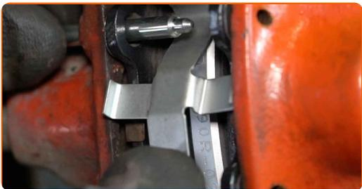
**45** Namestite vodilne čepe zavornih ploščic. Uporabite izbijač. Uporabite kladivo.
