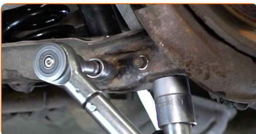
**23** Odstranite opornik izpod zadnjega prečnega vodila.
