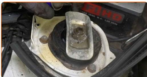
**5** Sprostite pritrdilni element batnice vzmetne noge. uporabite poseben nastavek za nasadni ključ za odstranitev blažilnika št. 22. Uporabite imbus št. H7. Uporabite izvijač z zatikalom.
