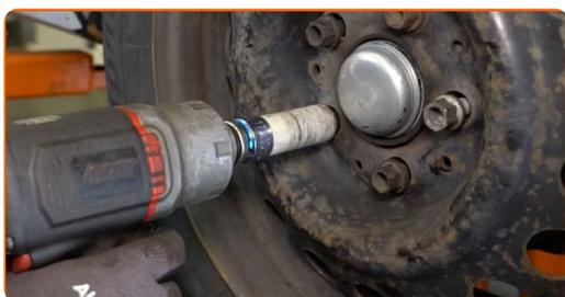
**37** Spustite avto in z delanjem v navzkrižnem vrstnem redu, zategnite kolesne vijake. Uporabite kolesni nasadni nastavek št. 17 Uporabite navorni ključ. Zategnite ga do navora 110 Nm.
