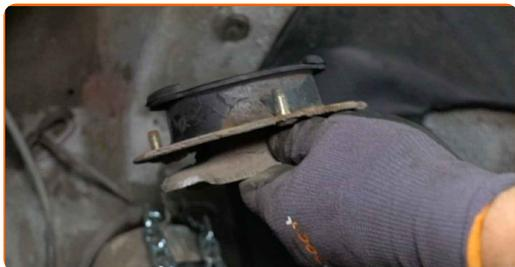
**23** Očistite pritrdilno mesto nosilca vzmetne noge. Uporabite žično krtačo. Uporabite večnamenski čistilni sprej.
