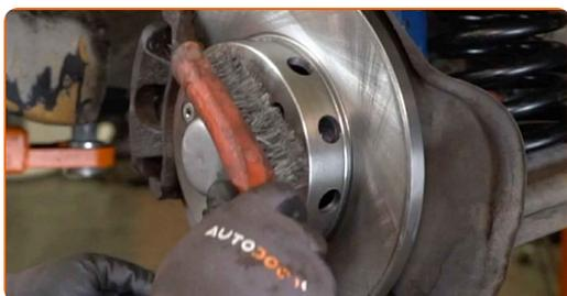
**34** Obdelajte površino, kjer se zavorni kolut stika s platiščem. Uporabite keramično pasto.
