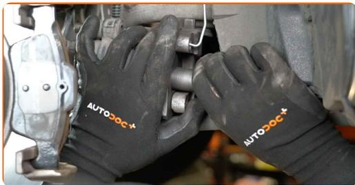
**19** Očistite umazanijo in prah iz nosilca zavorne čeljusti. Uporabite žično krtačo. Uporabite čisto zavor.
