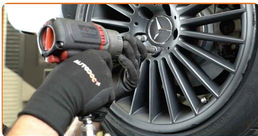
**32** Spustite avto in z delanjem v navzkrižnem vrstnem redu, zategnite kolesne vijake. Uporabite kolesni nasadni nastavek št. 17 Uporabite navorni ključ. Zategnite ga do navora 130 Nm.
