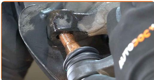
**15** Privijte pritrdilno matico, ki povezuje glavo jarmovega droga s premnikom. Uporabite nasadni ključ №21. Uporabite izvijač z zatikalom.
