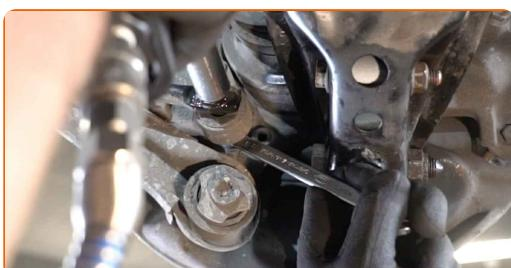
8 Odvijte pritrdilne elemente, ki povezujejo drog stabilizatorja na premnik. Uporabite nasadni ključ №E14. Uporabite izvijač z zatikalom.
