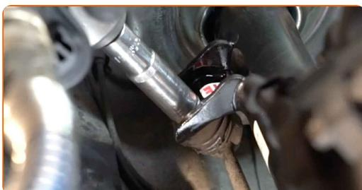
**8** Odvijte pritrdilni element, ki povezuje jarmov drog na palico stabilizatorja. Uporabite nasadni ključ №16. Uporabite izvijač z zatikalom.
