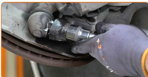
**9** Odklopite kroglični sklep s prečnega vodila. Uporabite snemalec nosilnega zgiba.
