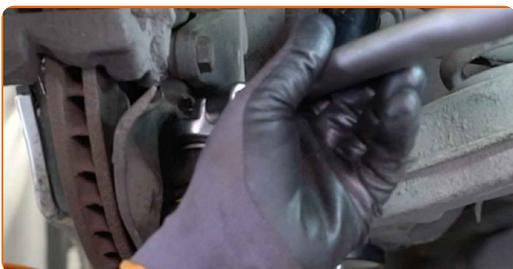
**19** Zategnite pritrdilni element, ki povezuje kroglični sklep s premnikom. Uporabite nasadni ključ №21. Uporabite navorni ključ. Zategnite ga do navora 105 Nm.
