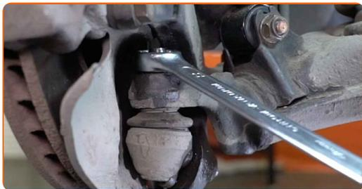
**8** Odvijte pritrdilni element, ki povezuje zglob na kontrolno ročico vzmetenja. Uporabite nasadni ključ №22. Uporabite izvijač z zatikalom.
