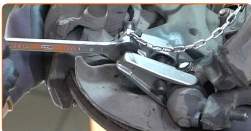
**10** Odklopite kroglični sklep s premnika. Uporabite snemalec nosilnega zgiba.
