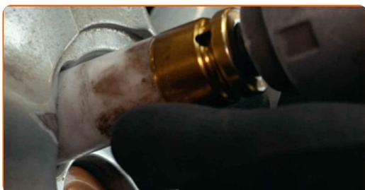
34 Spustite avto in z delanjem v navzkrižnem vrstnem redu, zategnite kolesne vijake. Uporabite kolesni nasadni nastavek št. 19 Uporabite navorni ključ. Zategnite ga do navora 90 Nm.
