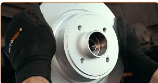
20 Zategnite matico kolesnega ležaja. Uporabite nasadni ključ №30. Uporabite navorni ključ. Zategnite ga do navora 175 Nm.
