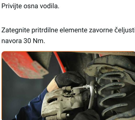
**23** Zategnite pritrdilne elemente zavorne čeljusti. Uporabite imbus št. H7. Uporabite navorni ključ. Zategnite ga do navora 30 Nm.
