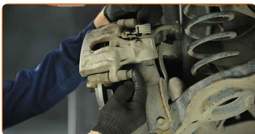
**25** Namestite blokirno vzmet zavorne čeljusti. Uporabite ploščat izvijač.
