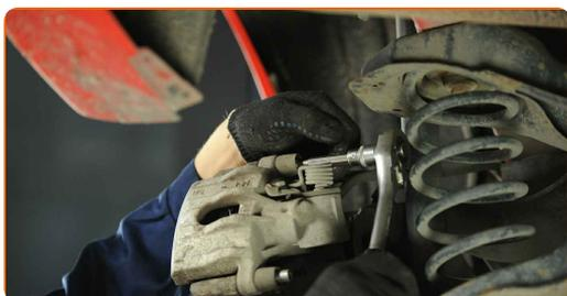
**24** Namestite pokrovčke manšete vodilnih zatičev zavornih čeljusti.
