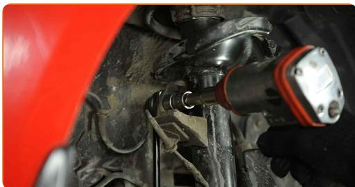
**8** Odstranite nosilec kabelskega snopa ABS.
