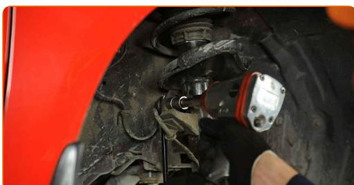
**8** Odstranite nosilec kabelskega snopa ABS.
