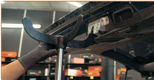
3 Sprostite obroč, ki povezuje plinsko vzet s karoserijo avtomobila. Uporabite ploščat izvijač.
