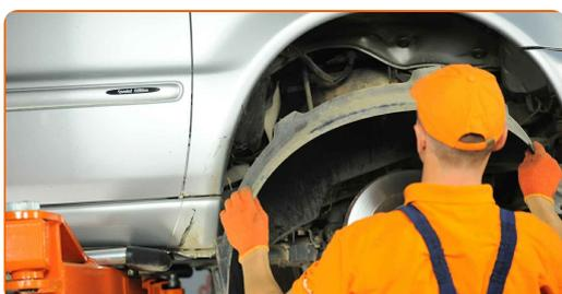
**8** Podprite ročico. Uporabite dvigalko s hidravličnim prenosom.
