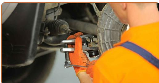
**16** Odstranite ABS senzor s krmilnega členka. Uporabite nasadni ključ N°10. Uporabite nasadni ključ N°E10. Uporabite izvijač z zatikalom.
