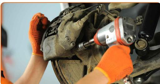
**9** Odstranite zavorno čeljust skupaj z njenim nosilcem. Uporabite ploščat izvijač.
