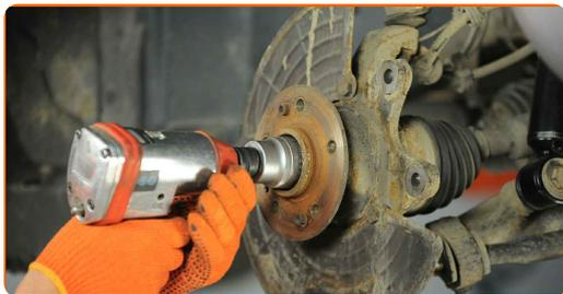
**14** Odvijte končno pritrdilno matico na volanskem členku. Uporabite nasadni ključ N°22. Uporabite izvijač z zatikalom.
