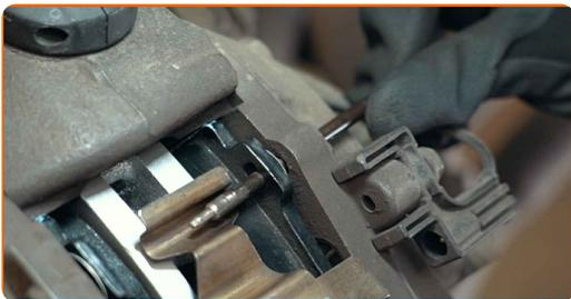
**17** Priključite vtič senzorja za obrabo zavornih oblog.
