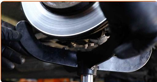
13 Odvijte pritrdilne elemente na vrhu nosilca amortizerja.
