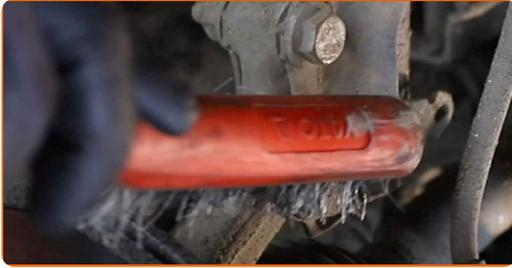
11 Odvijte pritrdilne elemente, ki povezujejo vzmetno nogo s premnikom. Uporabite kombinirani ključ №18. Uporabite nasadni ključ №18. Uporabite izvijač z zatikalom.
