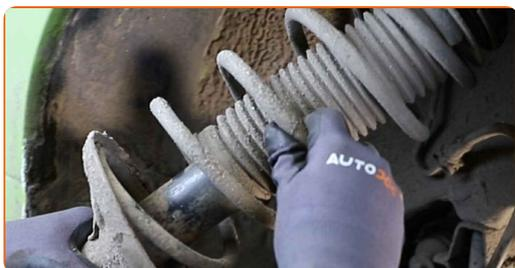
17 Nastavite opornik amortizerja na orodju kompresorja.
