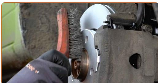
21 Obdelajte površino, kjer se zavorni kolut stika s platiščem. Uporabite bakreno mast.
