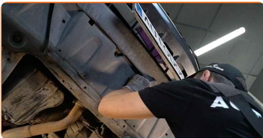
**21** Zategnite pritrdilne elemente na spodnjem pokrovu oljnega korita. Uporabite nasadni ključ №10. Uporabite izvijač z zatikalom.
