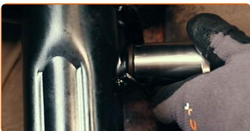
**8** Odvijte pritrdilni element, ki povezuje jarmov drog na palico stabilizatorja. Uporabite kombinirani ključ №18. Uporabite XZN št. 6. Uporabite izvijač z zatikalom.
