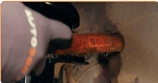
**7** Odvijte pritrdilni element, ki povezuje jarmov drog na blažilnik. Uporabite nasadni ključ №18. Uporabite XZN št. 6. Uporabite izvijač z zatikalom.
