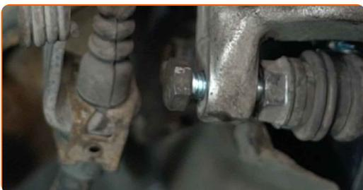
**36** Zategnite pritrdilne elemente zavorne čeljusti. Uporabite nasadni ključ №13. Uporabite navorni ključ. Zategnite ga do navora 35 Nm.
