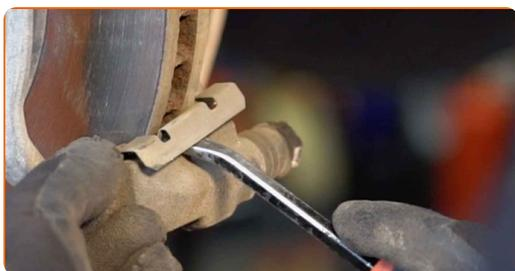
**12** Očistite umazanijo in prah iz nosilca zavorne čeljusti. Uporabite žično krtačo. Uporabite čisto zavor.
