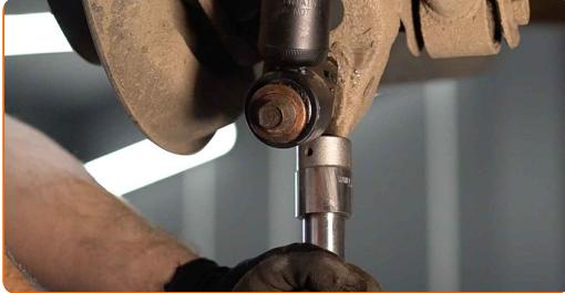
9 Sprostite pritrdilne elemente, ki povezujejo drog/opornik stabilizatorja na palico stabilizatorja. Uporabite kombinirani ključ №17. Uporabite imbus št. H6.
