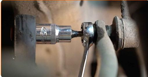
11 Odstranite drog stabilizatorja iz zadnjega nosilca vzmetenja.
