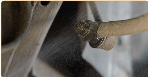
8 Odvijte pritrdilne elemente, ki povezujejo drog stabilizatorja na zadnji nosilec vzmetenja. Uporabite kombinirani ključ №12. Uporabite kombinirani ključ №14.
