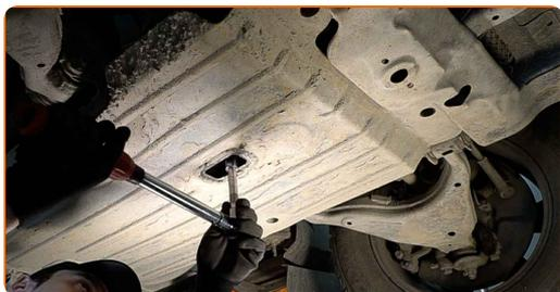
**15** Zategnite čep za izpust olja. Uporabite nasadni ključ №17. Uporabite navorni ključ. Zategnite ga do navora 30 Nm.
