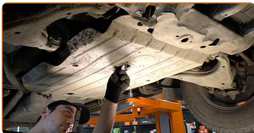
**14** Privijte nov čep za izpust olja. Uporabite nasadni ključ №17. Uporabite izvijač z zatikalom.
