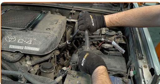
**11** Pripravite posodo za stari oljni filter. Odložite stari oljni filter v posodo.
