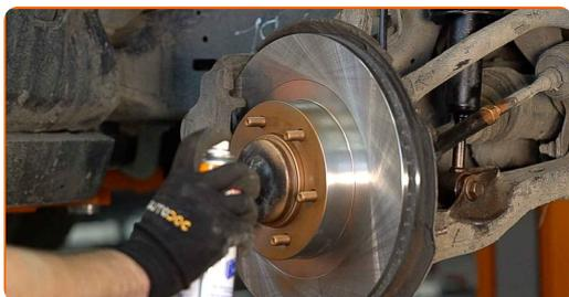
**20** Očistite površino zavornih kolutov. Uporabite čistilo zavor.
