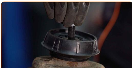
27 Zategnite matico amortizerja. Uporabite imbus št. H6. Uporabite kombinirani ključ №14. Uporabite navorni ključ. Zategnite ga do navora 60 Nm.
