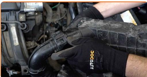
16 Zategnite objemko, ki pritrjuje ohišje zračnega filtra motorja na nastavek dušilnih loput. Uporabite ploščat izvijač.
