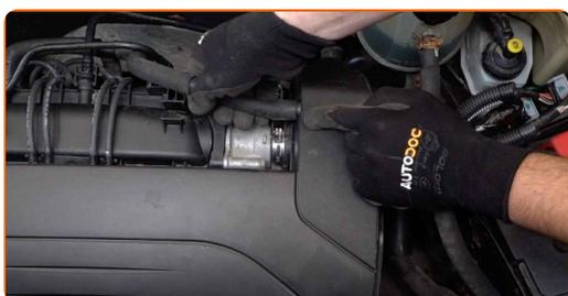
4 Odvijte objemko, ki pritrjuje ohišje zračnega filtra motorja na nastavek dušilnih loput. Uporabite ploščat izvijač.
