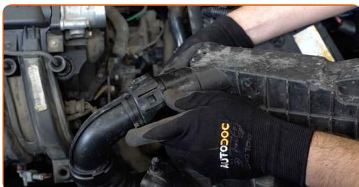
7 Odstranite pritrdilne vijake pokrova zračnega filtra. Uporabite vijačni nastavek T25.
