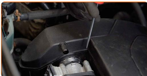
5 Odstranite ohišje zračnega filtra.
