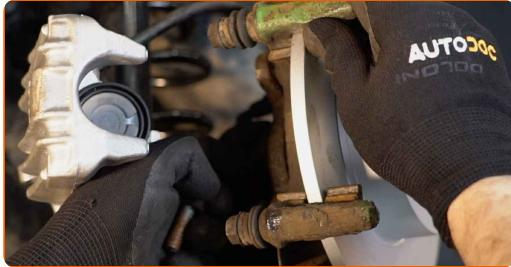
**21** Zategnite nosilec zavorne čeljusti. Uporabite imbus št. H10. Uporabite navorni ključ. Zategnite ga do navora 80 Nm.
