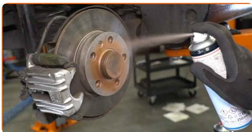
**31** Očistite površino zavornih kolutov. Uporabite čistilo zavor.
