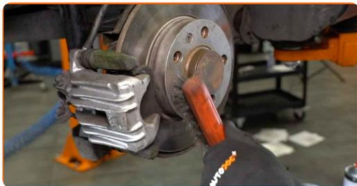
**30** Obdelajte površino, kjer se zavorni kolut stika s platiščem. Uporabite bakreno mast.
