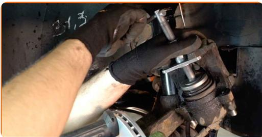
**14** Očistite umazanijo in prah iz nosilca zavorne čeljusti. Uporabite žično krtačo. Uporabite čisto zavor.
