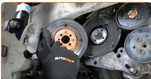
**100** Zategnite pritrdilni element jermenic ročične gredi. Uporabite imbus št. H6. Uporabite navorni ključ. Opazujte priporočeni zatezni navor.
