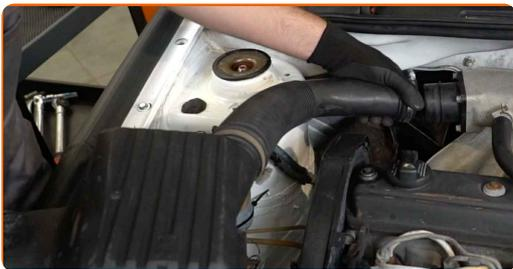
**10** Pokrijte nastavek dušilnih loput s krpo iz mikrovlakn, da preprečite vdor prahu in umazanije v sistem.
