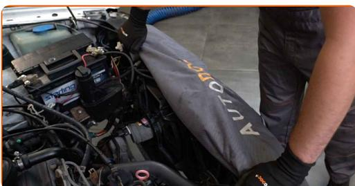
**3** Odvijte pritrdilne elemente terminalov avtomobilskega akumulatorja. Uporabite nasadni ključ №10. Uporabite izvijač z zatikalom.
