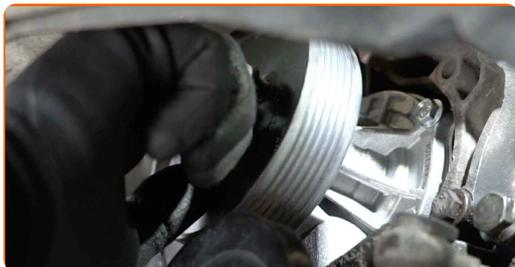
**98** Zategnite pritrdilni element jermenice vodne črpalke. Uporabite imbus št. H6. Uporabite navorni ključ. Opazujte priporočeni zatezni navor.
