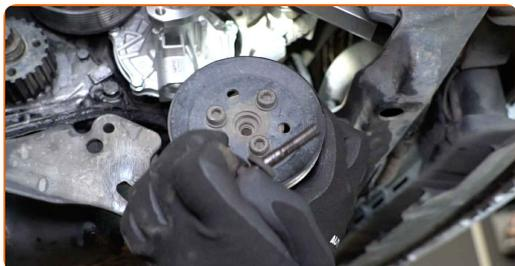
**75** Zategnite pritrdilne elemente črpalke hidravličnega servo krmiljenja. Uporabite nasadni ključ №13. Uporabite nasadni ključ №16. Uporabite navorni ključ. Opazujte priporočeni zatezni navor.
