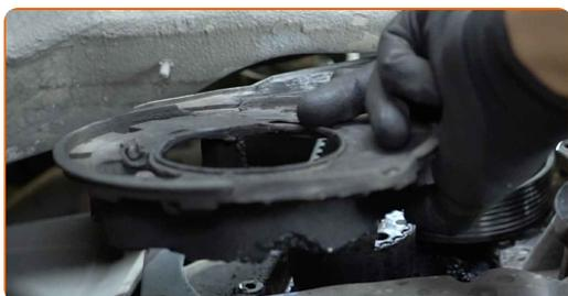
**37** Obrnite zobnik ročične gredi. Uporabite 12-točkovni nastavek Št. 19. Uporabite izvijač z zatikalom.
