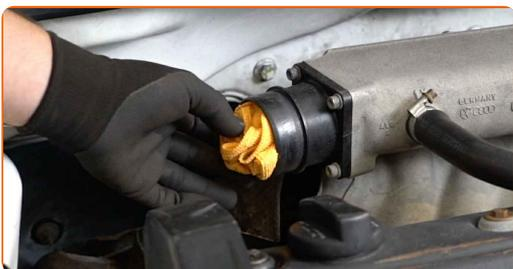
**11** Sprostite držala ohišja zračnega filtra. Odstranite ohišje zračnega filtra.
