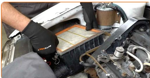
**109** Zapahnite držala ohišja zračnega filtra.
