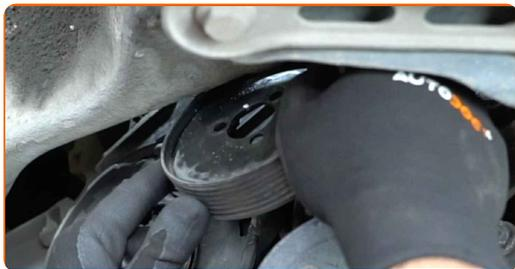
**35** Odvijte pritrditve spodnjega pokrova zobatega jermena. Uporabite nasadni ključ N°10. Uporabite izvijač z zatikalom.
