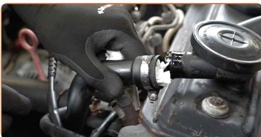
**44** Odvijte pritrdilne elemente pokrova ventila motorja. Uporabite nasadni ključ №10. Uporabite izvijač z zatikalom.
