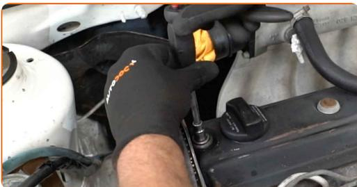
**45** Odstranite pokrov ventila motorja.
