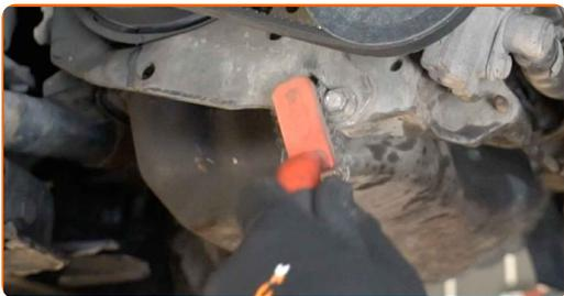
**23** Odvijte pritrdilne elemente črpalke hidravličnega servo krmiljenja. Uporabite nasadni ključ №13. Uporabite nasadni ključ №16. Uporabite izvijač z zatikalom.
