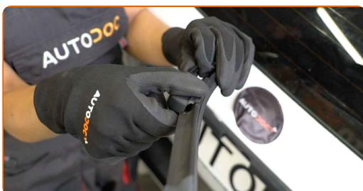
**4** Odstranite metlico iz ročice brisalnika.
