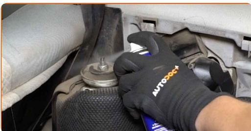
**6** Sprostite zgornji pritrdilni element sedeža za namestitev blažilnika. Uporabite kombinirani ključ №17. Uporabite nasadni ključ za blažilnik št. DD5,2. Uporabite izvijač z zatikalom.
