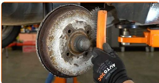
**47** Obdelajte površino, kjer se platišče kolesa dotika zavornega bobna. Uporabite bakreno mast.
