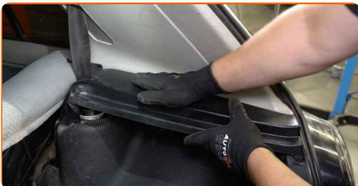
**55** Privijte pritrdilne elemente stranskega plastičnega okrasnega panela. Uporabite nasadni ključ №10. Uporabite izvijač z zatikalom.
