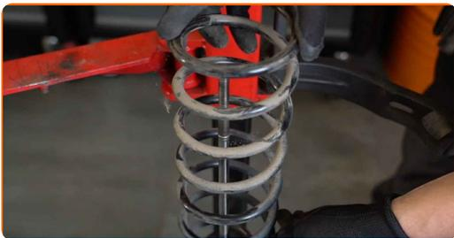
27 Odstranite stari amortizer s kompresorja hidravlične spiralne vzmeti.
