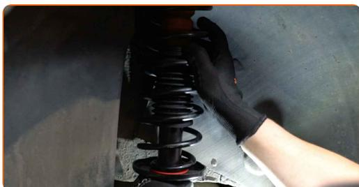
**37** Podprite zadnji nosilec vzmetenja. Uporabite dvigalko s hidravličnim prenosom.
