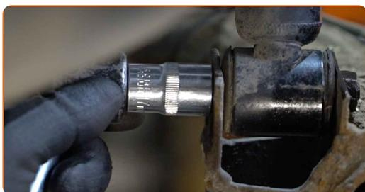
**15** Odvijte pritrdilne elemente na vrhu nosilca amortizerja.
