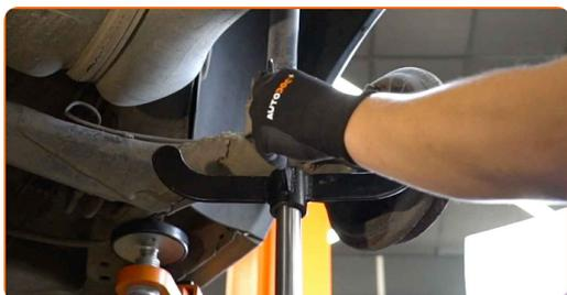
**14** Odvijte spodnjo pritrditev opornika amortizerja. Uporabite kombinirani ključ №17. Uporabite nasadni ključ №17. Uporabite udarni nasadni ključ.
