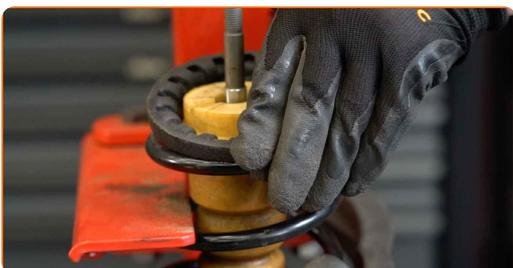
30 Namestite zgornji nosilec opornika in ležaj nosilca opornika.
