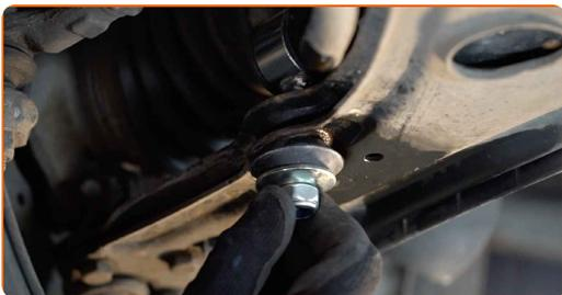
**11** Zategnite pritrdilni element, ki povezuje drog stabilizatorja z vilicami. Uporabite nasadni ključ №19. Uporabite navorni ključ. Zategnite ga do navora 35 Nm.
