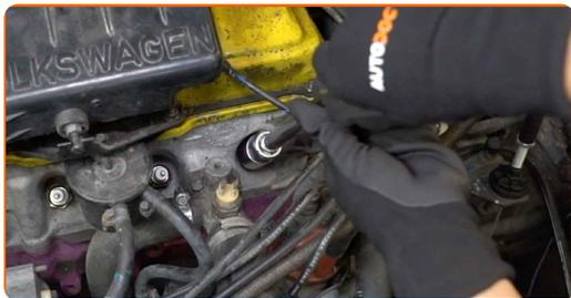
**9** Vstavite nove svečke in jih pričvrstite. Uporabite nastavek ključa za vžigalne svečke št. 21. Uporabite navorni ključ. Zategnite ga do navora 25 Nm.
