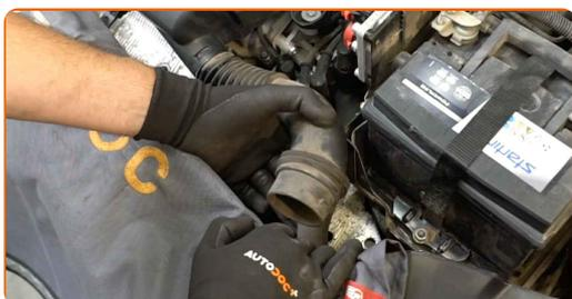
**4** Odstranite pritrdilne vijake pokrova zračnega filtra. Uporabite nasadni ključ N°10. Uporabite izvijač z zatikalom.
