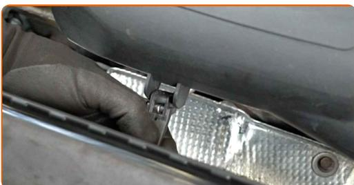
**20** Priključite dovodno cev zraka na ohišje zračnega filtra.
