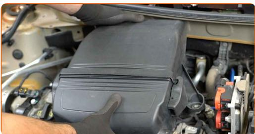
**7** Pokrijte nastavke dušilnih loput s krpo iz mikrovlačen, da preprečite vdor prahu in umazanije v sistem.
