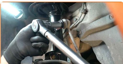
**53** Obdelajte pritrdilne elemente blažilnika. Uporabite bakreno mast.
