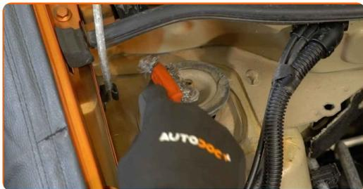
**4** Sprostite zgornji pritrdilni element sedeža za namestitev blažilnika. Uporabite imbus št. H7. Uporabite nasadni ključ №19. Uporabite izvijač z zatikalom.
