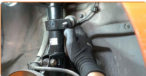
**52** Zategnite pritrdilni element, ki povezuje jarmov drog na blažilnik. Uporabite nasadni ključ №16. Uporabite navorni ključ. Zategnite ga do navora 23 Nm.
