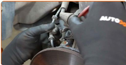
**12** Očistite pritrdilne elemente opornikov stabilizatorja. Uporabite žično krtačo. Uporabite sprej WD-40.
