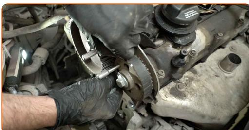
52 Odvijte pritrdilne elemente stranskega pokrova zobatega jermena. Uporabite nasadni ključ №10. Uporabite imbus št. H6. Uporabite izvijač z zatikalom.
