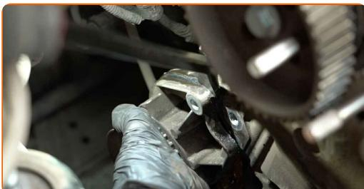
54 Odvijte pritrditve vodne črpalke. Uporabite imbus št. H6. Uporabite izvijač z zatikalom.
