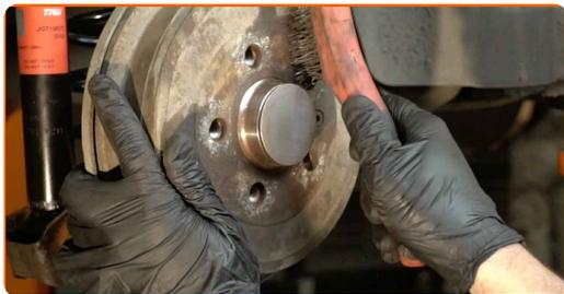
**35** Obdelajte površino, kjer se platišče kolesa dotika zavornega bobna. Uporabite bakreno mast.
